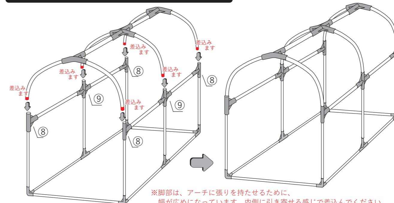
アーチパイプはしつかり、奥まで差込んでください。半端な差込みですと、骨組の強度が落ちます。また、ジョイントに負荷がかかりやすくなり、破損の原因に繋がります。
