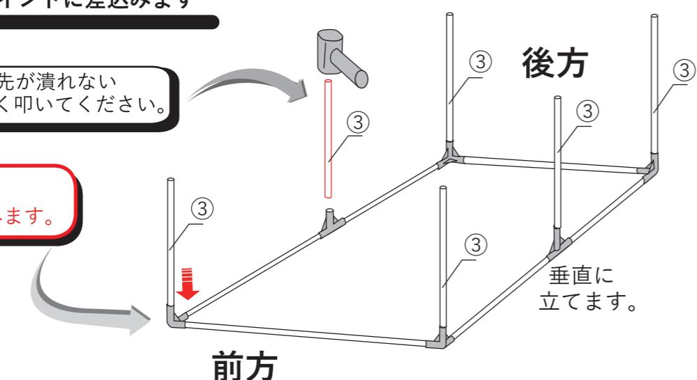
5 各ジョイントと④横通し用パイプを組立て、③脚用パイプに差込みます
