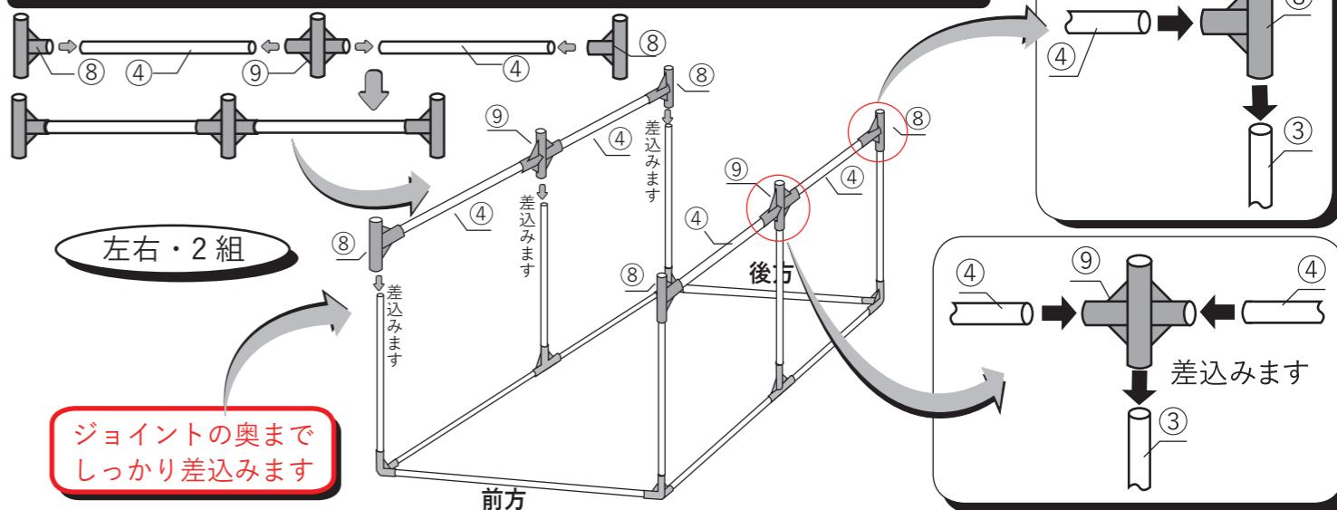
**6** ⑤アーチ用パイプ・⑥天井横通し用パイプを、⑩⑪ジョイントに差込み、天井部を組立てます
